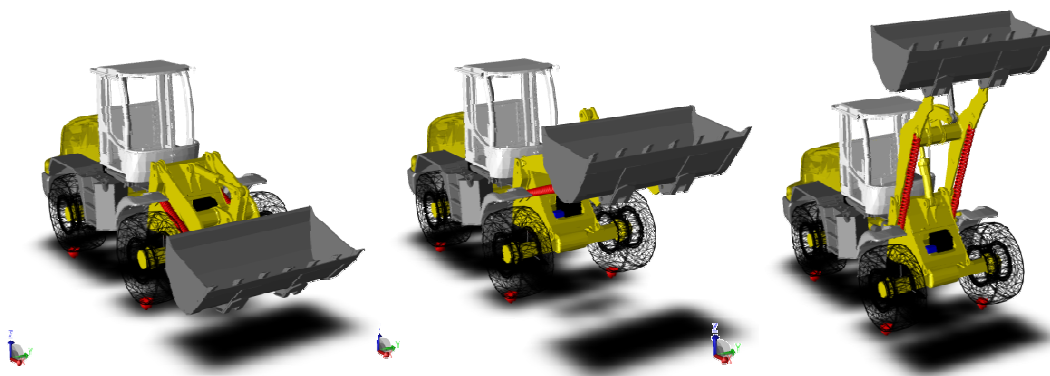
Bild 4: Parametrischer Aufbau des Gesamtfahrzeugmodells (Bsp. Hubgerüststellung)
