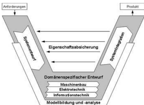
Abbildung 1: V-Modell in der Entwicklung von mechatronischen Systemen [1]
