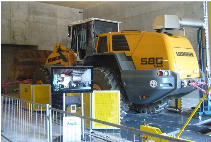
Abb. 9. Realer Prototyp am Allrad-Rollenprüfstand des KIT
