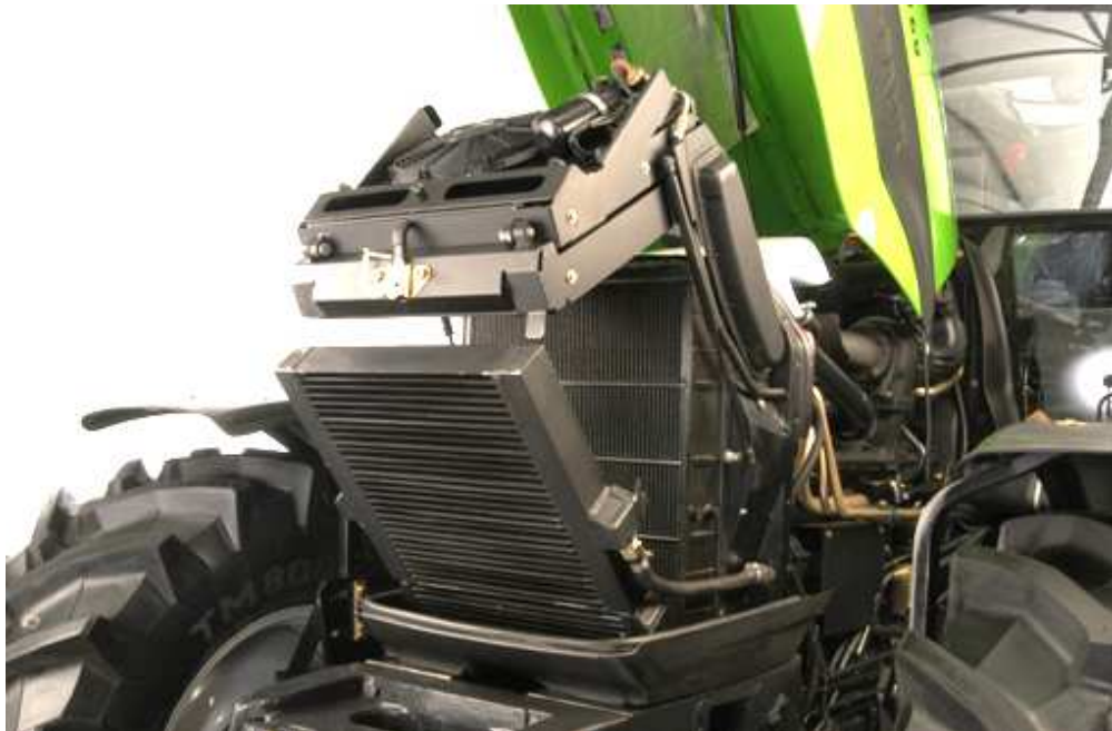
Bild 2.3 : aufklappbare Kühler von Deutz-Fahr, Werkbild [REN07]
