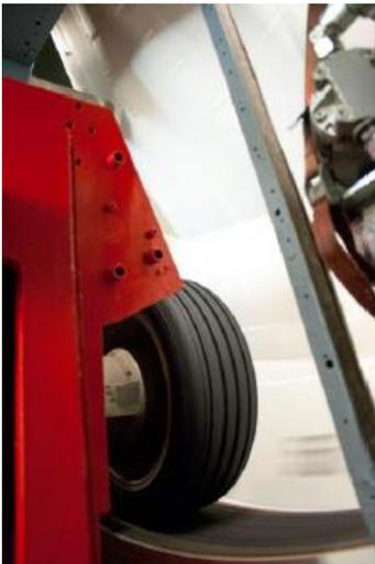
Reifen-Fahrbahn Geräusch ist heute die Hauptkomponente des Verkehrslärms und muss bis 2020 von 6 Dezibels reduziert werden. Am Institut für Fahrzeugsystemtechnik werden zu diesem Thema unter anderem Reifenmessungen an einem Innentrommelprüfstand (siehe Abbildung links) durchgeführt.
